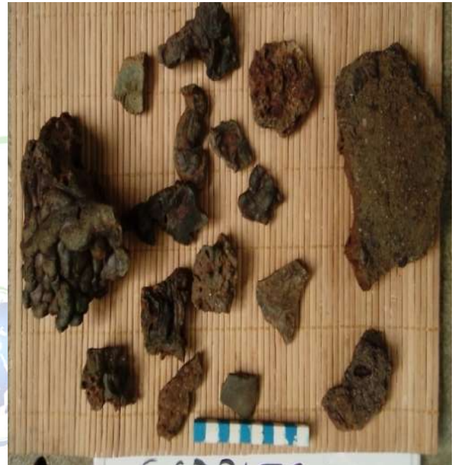
Figure 3 : Échantillons de scories prélevées sur le site métallurgique
